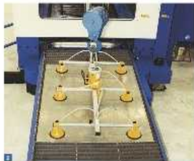
Fig. 1 - Applicazione manuale sistema a ventose distribuito da Tecnomovint per sollevamento lamiera. Fig. 2 - Esempio applicazione su impianto taglio laser di sistema manuale a ventose per lamiera fino a 2.800 x 1.500 mm. Fig. 3 - La versione elettrica del sistema a ventose distribuito da Tecnomovint permette di effettuare ribaltamenti sino a 180 gradi. Fig. 4 - Versione elettrica sistema telescopico su lastre da 1.200 x 2.000 mm.
