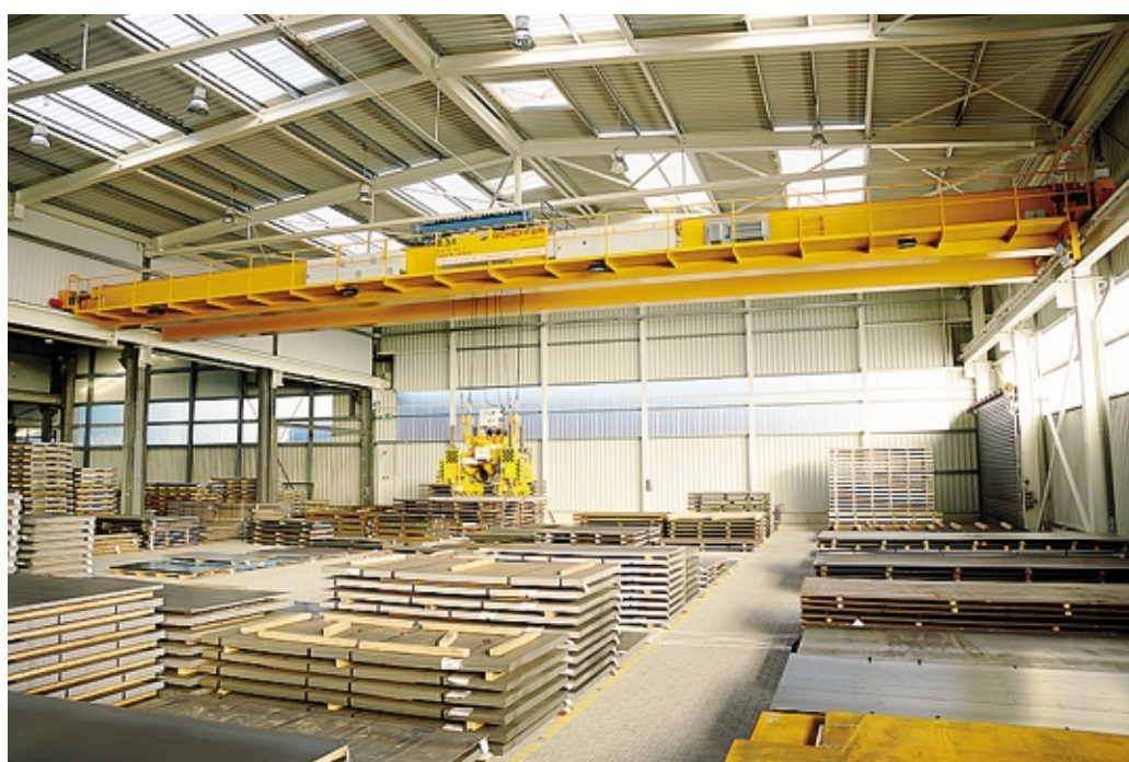
Ogni gru è concepita per resistere a un numero massimo di cicli di sollevamento
